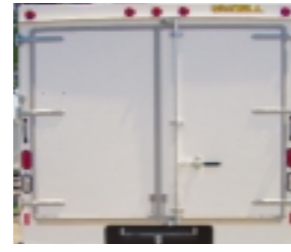
Portes arrières pivotantes, pleine-largeur
